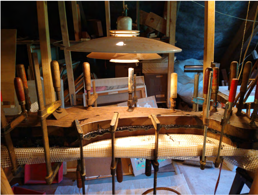
Billede 7 viser det hægebord jeg bruger fra en anden vinkel. Det vigtige er, at det er en ca. 30 cm. lang helt plan planke så skruetvingerne kan nå ind og få fat fra begge sider. Det ville de jo ikke kunne hvis det var et bord.
