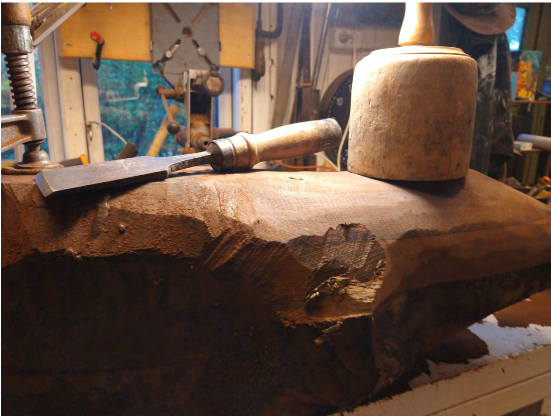
6. Nærbillede af træet efter huljern - og kanterne sliber jeg væk med rondelsliberen.
