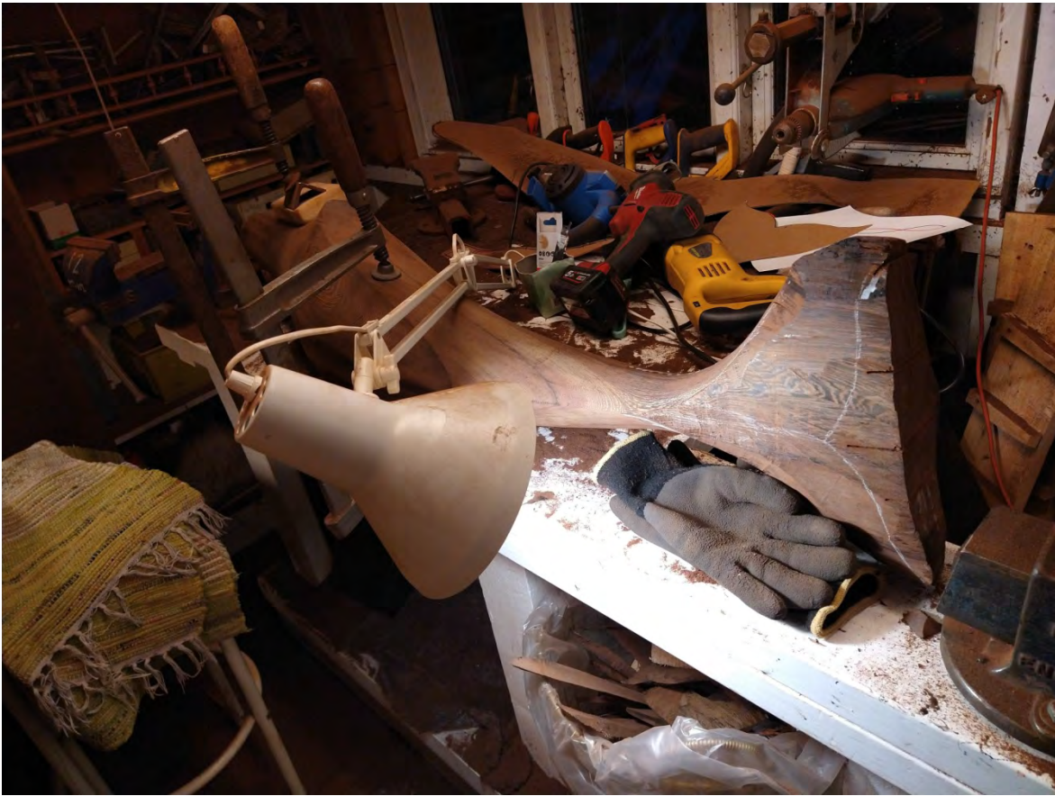
Foto 10 viser de færdigsavede halefinner. Den mørke streg er en prøve med vand for at se hvor mørk overfladen bliver når den får olie.
