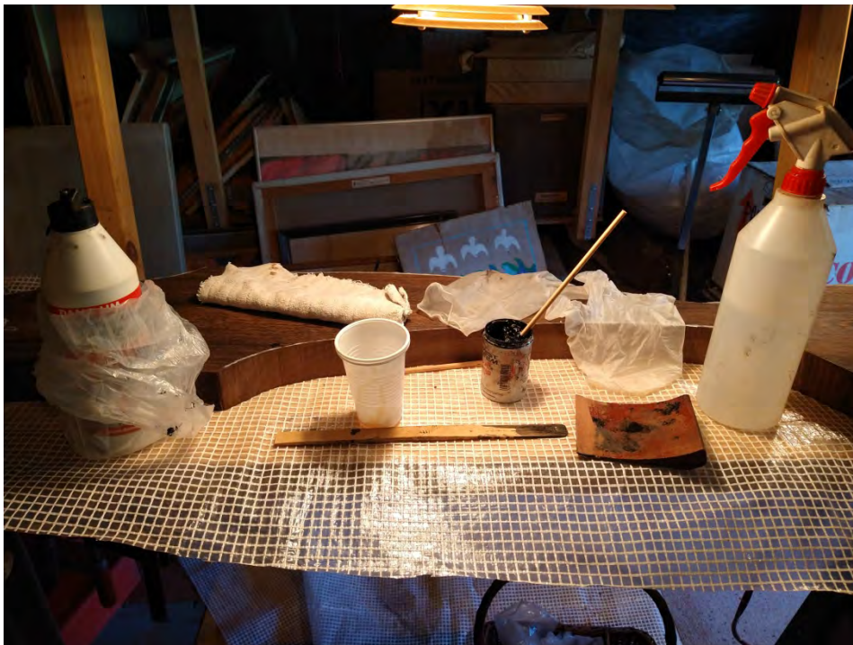
Billede 3: Det øverste lag vendes og lægges ovre til højre. Begge overflader sprayes med vand og overskudsvand tørres af med en våd klud. Straks og hurtigt blandes lim og farve og smøres på. Det er en væsentlig udfordring at få limen jævnt, jeg bruger en flad skraber som siden slibes fri for lim. Du kan se lysreflekserne i den påførte lim i det lag, som ligger helt til højre. Bemærk også plastik på gulvet hvis limen drypper.
