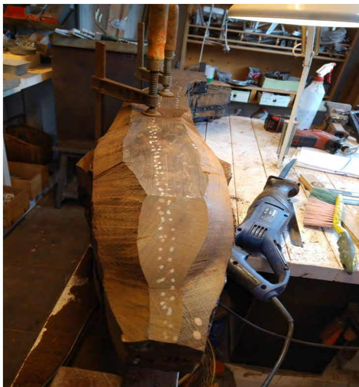
Det 13. billede viser afmærkningen af nakken, som skal formes med vinkelsliberen med fræser i stedet for skive, som ligger bagved.
